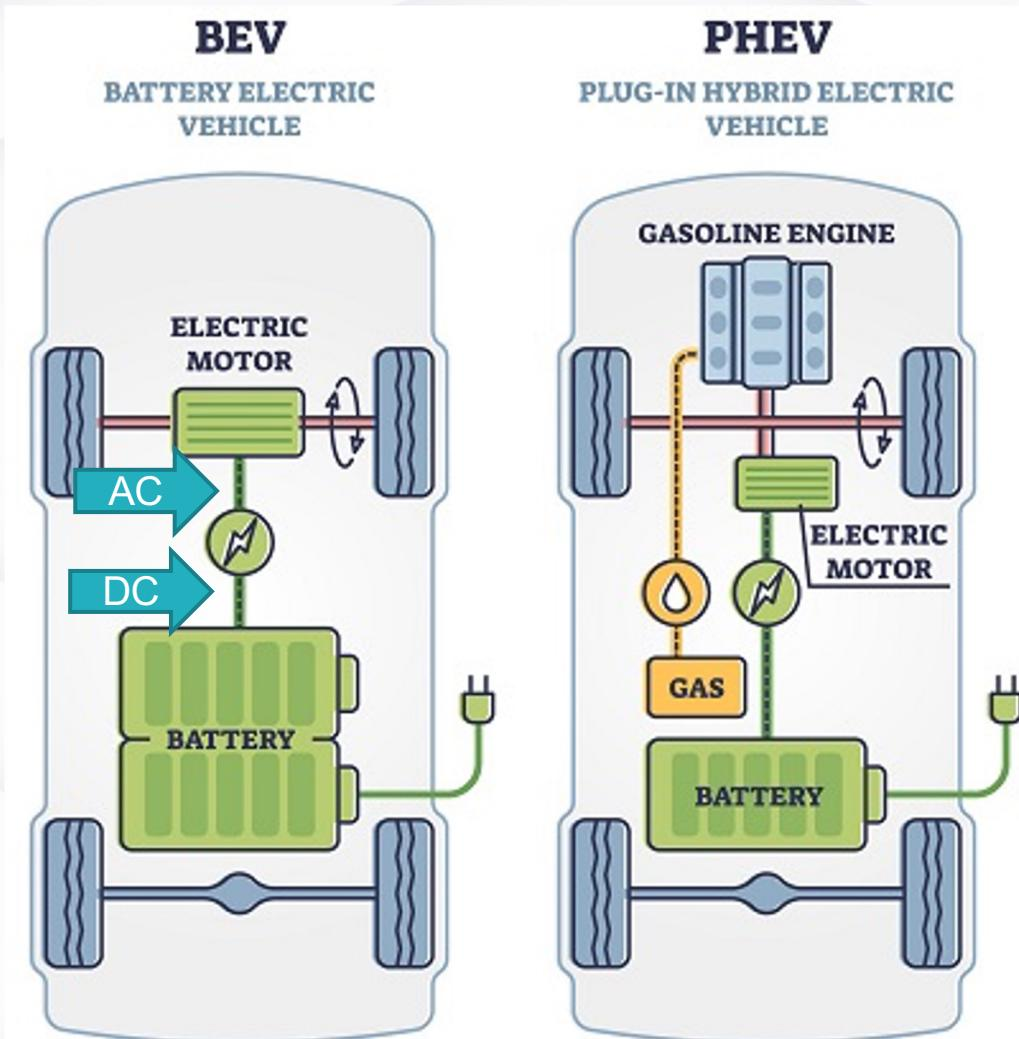
La energía almacenada en la **batería** es transferida al **inversor**, cuyo propósito es transformar la corriente continua (DC) suministrada por las baterías en corriente alterna (AC), ajustando la frecuencia para controlar la velocidad del **motor**.
